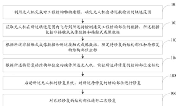
1. 一种基于无人机进行建筑检测修复的装置,所述装置包括无人机主体、无人机机臂、无人机螺旋桨和定位系统,所述无人机螺旋桨通过所述无人机机臂与所述无人机主体连接,所述定位系统位于所述无人机主体内,其特征在于,包括:安装于无人机主体上的非接触式成像系统、安装于无人机主体上的接触式成像系统、修复系统、飞行控制系统和地面控制系统,所述非接触式成像系统用于采集建筑渗漏水区域的图像和建筑裂缝区域的图像,所述接触式成像系统用于采集建筑结构外层剥落区域的图像,所述飞行控制系统用于根据所述定位系统的定位信息控制所述非接触式成像系统和接触式成像系统采集图像,所述地面控制系统与所述飞行控制系统连接,所述地面控制系统分别与所述非接触式成像系统和所述接触式成像系统连接,所述地面控制系统用于获取建筑结构图像信息,所述修复系统分别与所述飞行控制系统和所述地面控制系统连接,所述修复系统用于在所述地面控制系统和所述飞行控制系统的带动下到达建筑结构待修复区域并进行修复。
